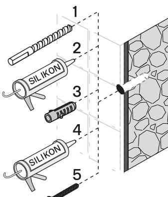
SV - OBS: Alla infästning i våzon 1 och 2 ska tätas mot väggens eller golvets tätskikt. Material för tätning ska fästa mot underlaget och vara vattenbeständigt, mögelresistent och åldringsbeständigt. Beroende av väggmaterial, skall metoden för väggmontering anpassas (Ev. förborning, plugg etc.). Tala med Er återförsäljare. Denna produkt är anpassad till Branschregler Säker Vatteninstallation. Leverantören garanterar produktens funktion om branschreglerna och produktens monteringsanvisning följs.
